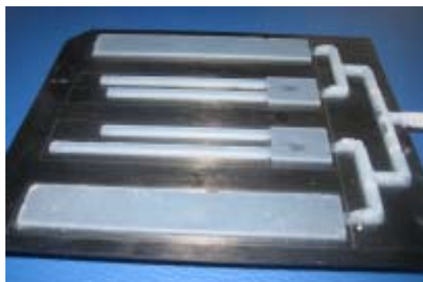
Bild: Duroplast (schwarz) und LSR (weiß) mit guter Haftung.
