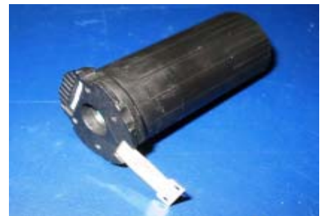
Bild: Duroplast (schwarz) und LSR (weiß) mit guter Haftung.
