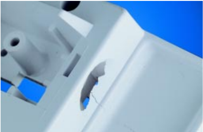
Bild 18.3: Riß durch eine Schwindungsbehinderung /5/
