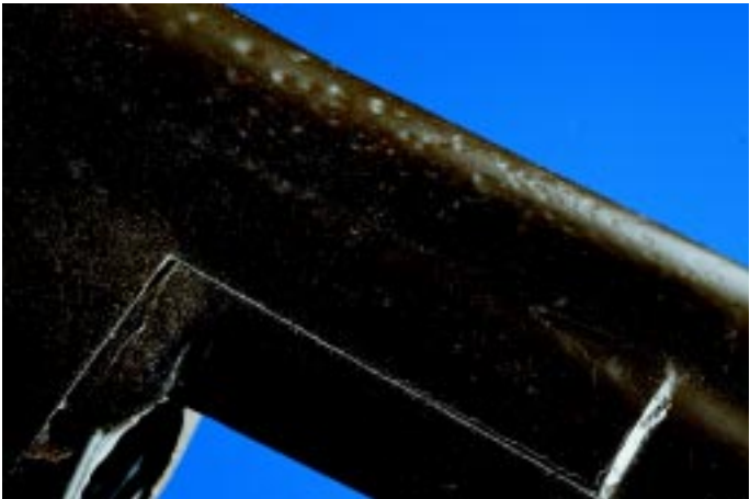
Bild 19.3: Einfallstellen an einem Topfgriff /1/
