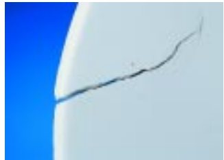
Bild 18.2: Riß durch eine Materialanhäufung /1/
