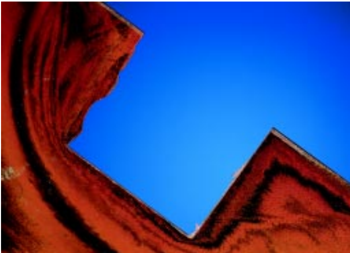
Bild 6.3: Staubereich vor einem Kern in der Mitte des Formteils /3/
