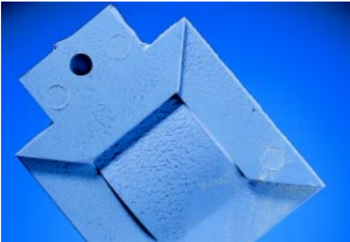
Bild 21.2: Auswerferabdrücke an einer Platte /4/
