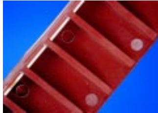
Bild 21.1: Auswerferabdrücke an einem flächigem Formteil /1/
