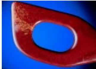
Bild 13.2: Schaber mit Glanzabweichungen /5/
