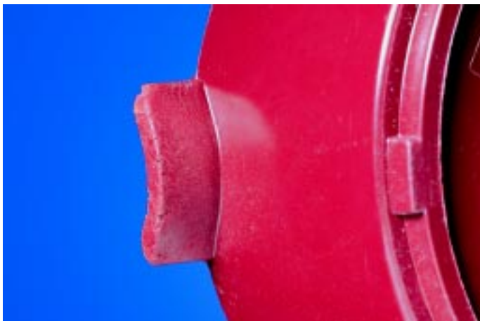
Bild 16.3: Porositäten am Fließwegende /2/
