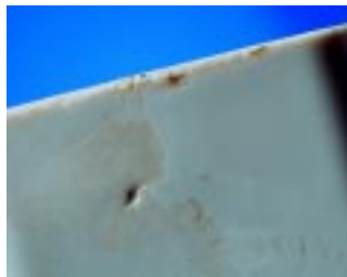
Bild 2.2: Deseleffekt am Fließwegende /1/
