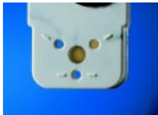
Bild 10.1: Farbschlieren durch Verunreinigungen /2/
