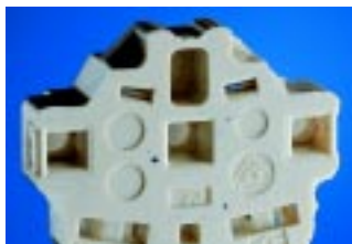
Bild 5.1: Verunreinigungen an einem Unterputzsockel /2/
