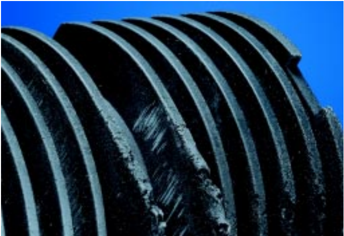
Bild 20.2: Kratzer im Bereich von Rippen /2/
