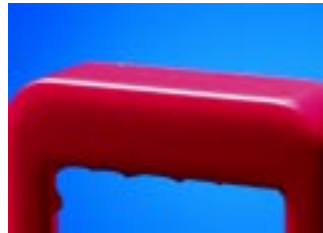
Bild 12.2: Fließlinien im Bereich von Kernen /5/
