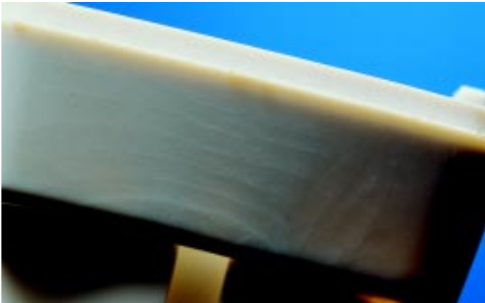
Bild 12.3: Fließlinien im Bereich des Fließwegendes /1/
