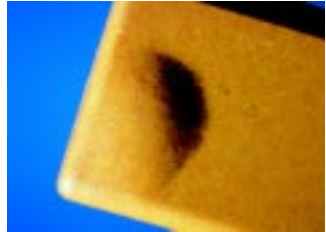
Bild 17.1: Dosendeckel mit großen Blasen /1/
