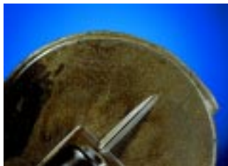
Bild 16.1: Porositäten an einem Deckel /4/
