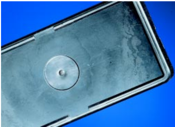
Bild 7.1: Wolkenbildung im Bereich eines Kernes /2/
