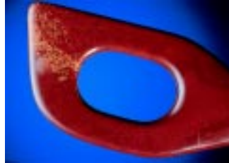
Bild 1.1: Matte Stellen an einem Löffel /5/
