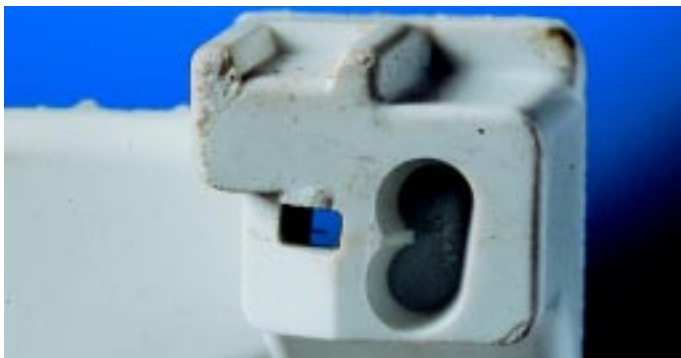
Bild 2.3: Deseleffekt an einer Rippe /2/
