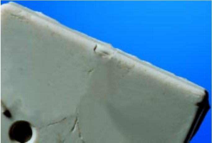
Bild 6.1: Anvernetzter Pfropfen an einem Unterputzsockel /2/
