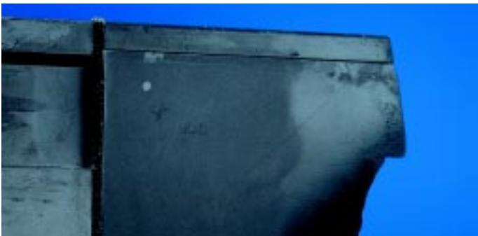
Bild 1.3: Matte Stellen an einem Elektrobauteil
