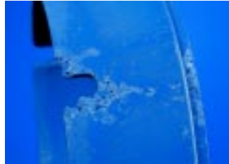
Bild 9.1: Glasfaserschlieren an einem Aschenbecher /2/
