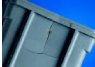
Bild 18.1: Risse in Anschnittnähe /2/
