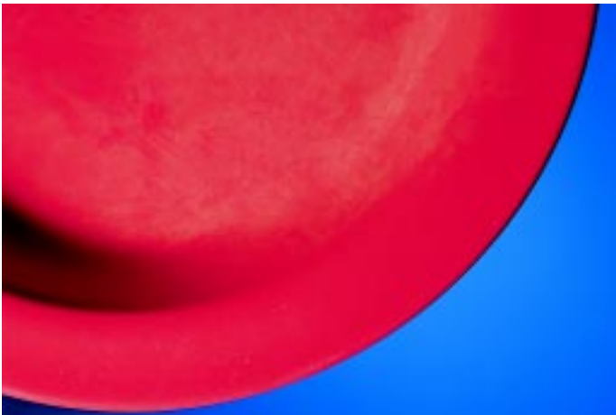
Bild 13.3: Teller mit Glanzabweichungen /4/
