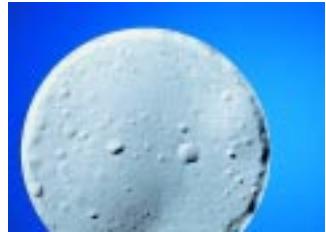
Bild 17.2: Preßteil mit kleinen Blasen /6/
