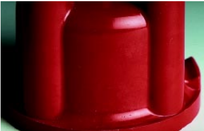
Bild 4.1: Große Brandflecken an einem Verteilerkanal /2/
